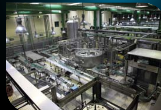
Proizvodni trak, ki lahko napolni 60.000 steklenic piva na uro.
